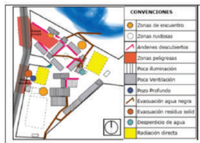
Figura 5. Localización de las problemáticas constructivas de la institución. Fuente: Elaboración Viviana Álvarez Sepúlveda 2014.
